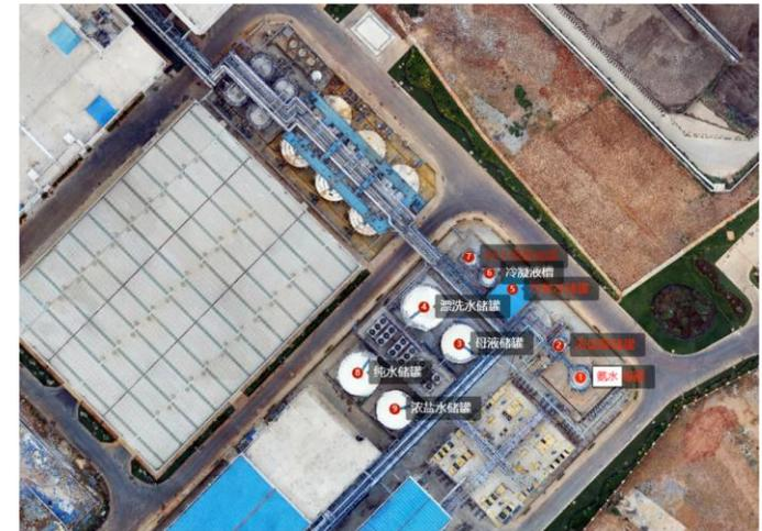
本项目危险化学品储罐包括氨水储罐、浓硫酸储罐、双氧水储罐、85%磷酸储罐，采取抗渗混凝土+耐腐蚀砖进行防渗，防渗性能等效渗透系数 $\leq 1.0 \times 10^{-7}$ cm/s。
